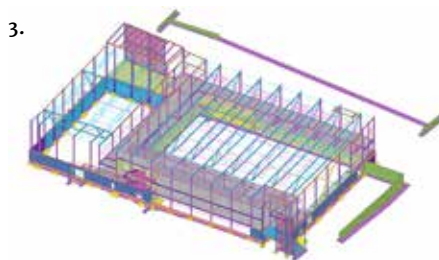
Kuva 3: AGCO Power Arenan koko teräsrunko Tekla-mallista katsottuna.
